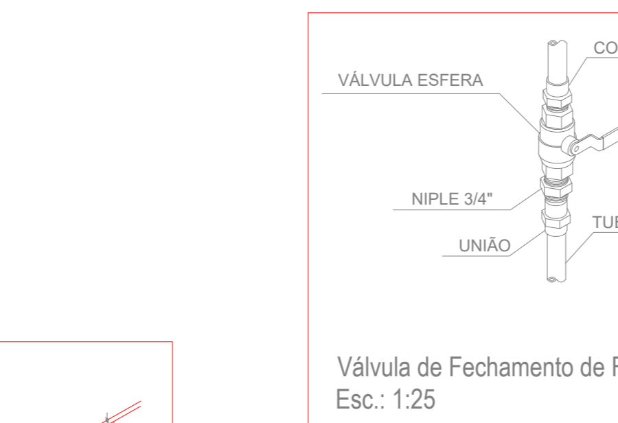
Válvula de Fechamento de Fluxo do GLP Esc.: 1:25
